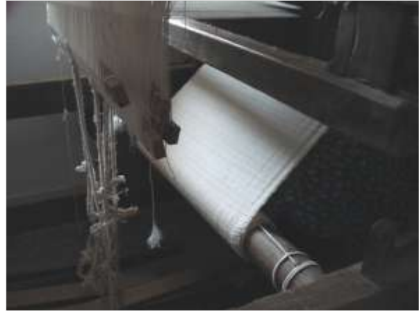
22. kép. Szövőszék felső hengere, „durungja” 23. kép. Szövőszék alsó hengere, „durungja”
